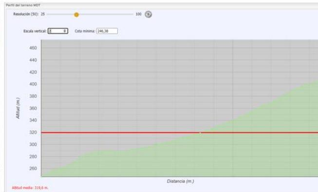
Altitud mínima A: 246,38 m / Altitud máxima A': 405,38 m / Distancia A-A': 727 m / Pendiente: 21,87%
