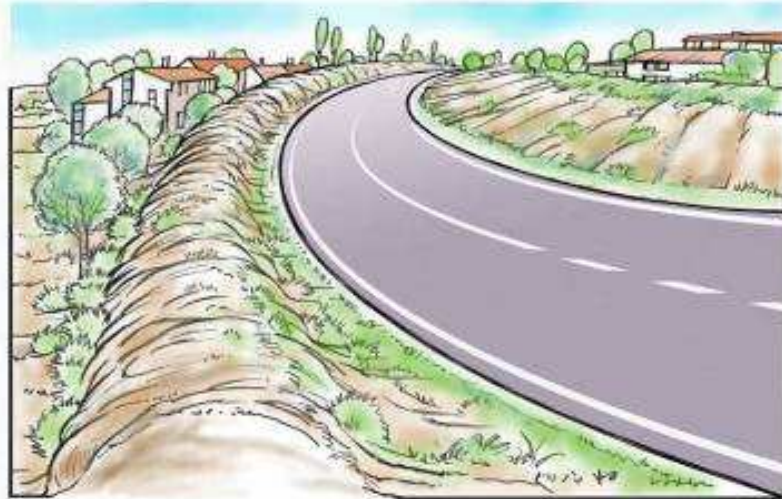
Medidas de atenuación sonora: Dique de tierra (arriba), para su implantación se requiere espacio suficiente y material sobrante.
