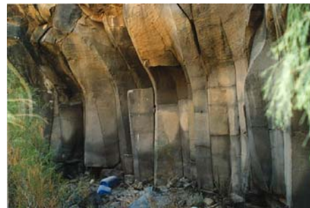
Imagen II.6.6.1.1. Aspecto de la parte masiva de colada basáltica en el Bco. del Helecho. Pueden observarse sus dos sistemas de fracturación, subvertical y planar.
