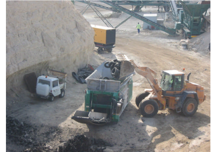
Foto 15. Trituradora de neumáticos del vertedero de Arico.
