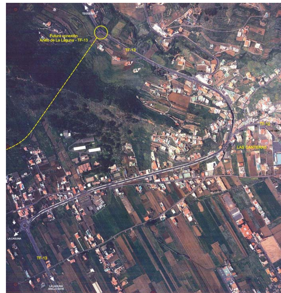
El nuevo trazado evita al núcleo de las Canteras, para lo cual el cruce con la TF-13 se desplaza hacia el oeste del mismo.
